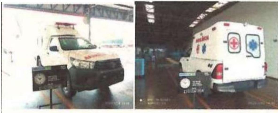
Por estas fotos, **aparentemente** se trata da instalação de uma CAPOTA, ao invés de um BAÚ.
